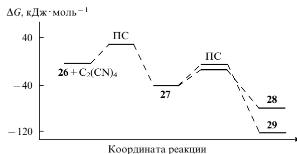
Рис. 10. Энергетический профиль реакции тиокарбонилилида 26 с тетрацианоэтиленом.
